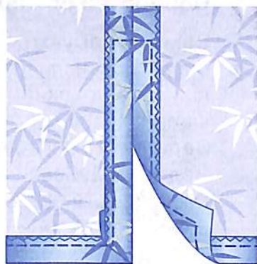
Рис. 70. Обработка разреза в шве
