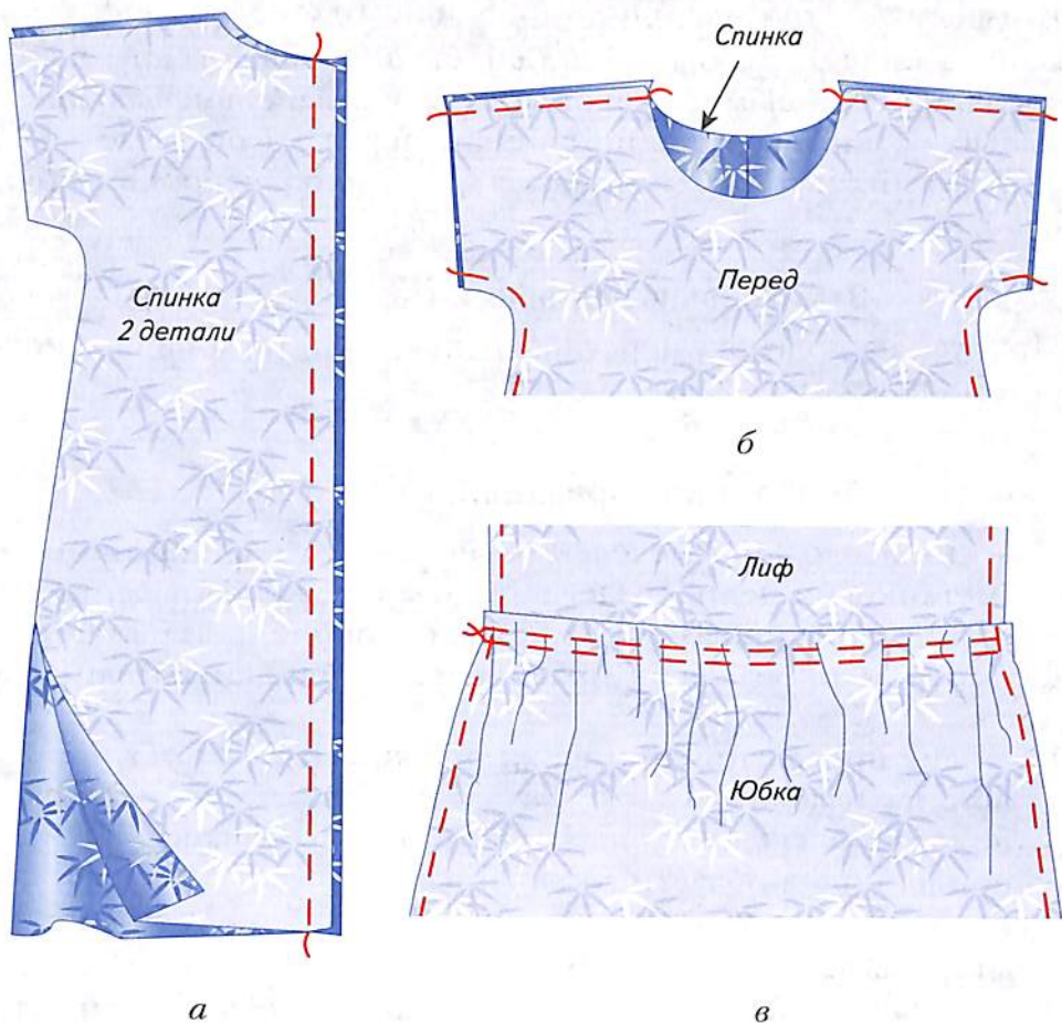
Рис. 59. Смётывание: а – среднего шва спинки; б – плечевых и боковых срезов; в – лифа с юбкой
