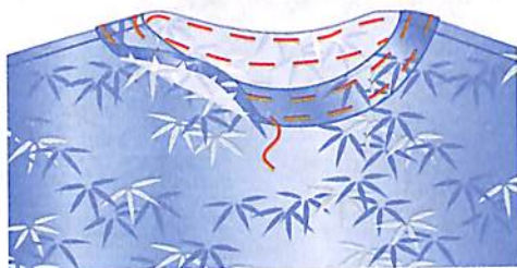
Рис. 65. Обработка горловины обтачкой, расположенной на лицевой стороне изделия
