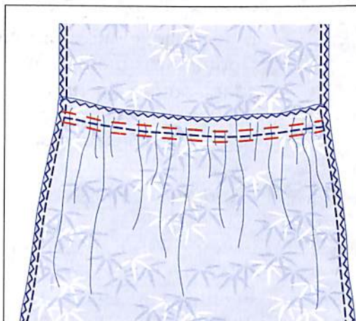
Рис. 68. Стачивание лифа с юбкой и обмётывание срезов
